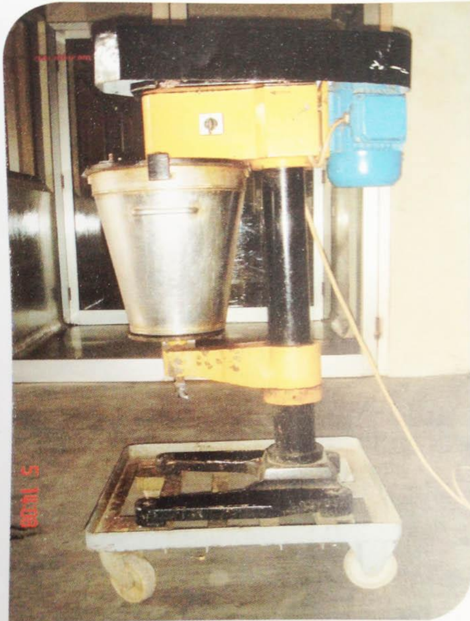
Gambar Pengaduk Elektrik PT. Jamu Jago
